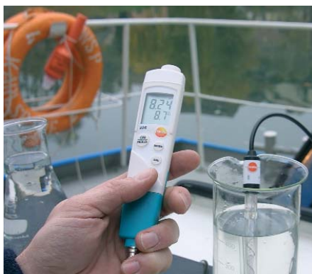
Compensação automática de temperatura em sondas externas com sensor de temperatura
