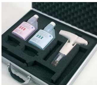
Kit maleta com testo 205, pH 4.0 e solução 7.0 tampão de armazenamento
