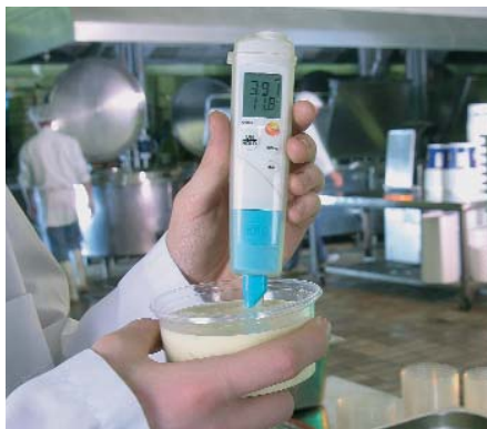
testo 206-pH2 ideal para medições em substâncias semisólidas.
