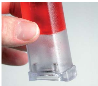
A solução de cloreto de potássio contida em gel, não goteja
