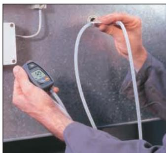
Medición de velocidad con tubo de Pitot
