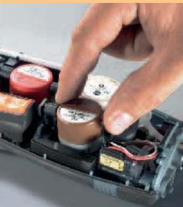
O Testo 335 é equipado com célula de O<sub>2</sub> como padrão. Duas células adicionais como CO, NO, CO<sub>baixo</sub>, NO<sub>baixo</sub>, NO<sub>2</sub> ou SO<sub>2</sub> podem ser selecionadas pelo usuário. Isto garante uma maior flexibilidade e adaptação em diferentes aplicações. Pelo fato dos dados de ajuste entre célula/instrumento ficarem armazenados própria célula, ela pode
