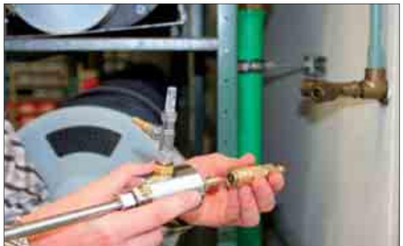
Conexión de la sonda para trazas de humedad testo 6615 vía cámara de medición y pre-filtro
