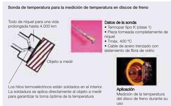
Sonda de temperatura para medir la temperatura en discos de freno 0699 3472
