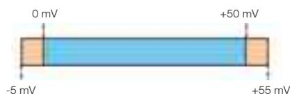
Los valores máximos en °C corresponden a los voltajes máximos de entrada (-5 mV...+55 mV) que el transmisor puede procesar. (Voltaje termoeléctrico de acuerdo a IEC 584-1)
