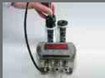
Reajuste con soluciones salinas de calibración
